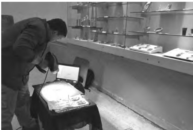
Obr. 1 Skenování fajánsové tabulky (amuletu) z Kurru, zobrazující tři božstva, pomocí skeneru VIUScan. Předmět menších rozměrů (7,4 × 8,8 × 0,7 cm) je umístěn na podložce s přednastavenými pozičními značkami. Na snímku je možné vidět skenovaný objekt, vlastní skenování i vytváření záznamu v počítači (foto J. Kroužek)
